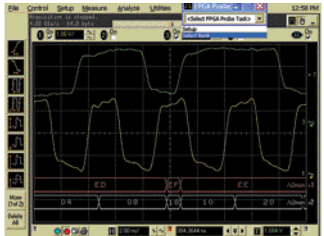
図 1 Agilent Technologies 社のミックスド シグナル オシロスコープは、4 つのアナログ チャンネルに加え、16 のデジタル チャンネルを提供します。最大 20 の信号までトリガして表示できます。デジタル チャンネル幅は、サイリンクス FPGA の内部信号を測定するのに最適です。
