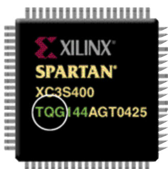
図 2 ザイリンクスの鉛フリー製品には、製造番号に「G」が追加されている
