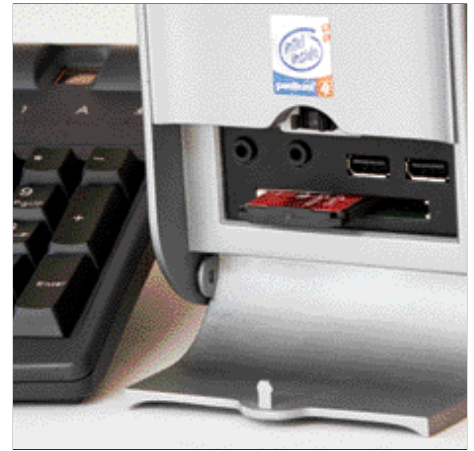
図 1 ノートブック (a) とデスクトップ (b) コンピュータに差し込む ExpressCard モジュール (写真提供: PCMCIA)
