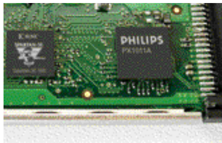
図 3 DVB-T ExpressCard/34 デモストレータに組み込まれている ザイリンクス Spartan-3E FPGA と Philips PX1011A
