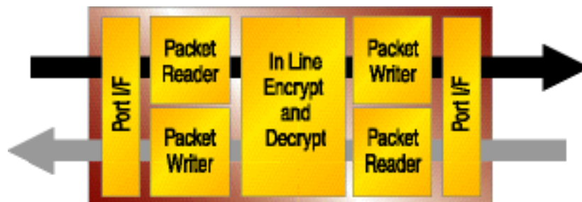
図 2 インラインのデータセキュリティプロセッシング
