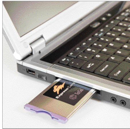
図 1 ノートブック (a) とデスクトップ (b) コンピュータに差し込む ExpressCard モジュール (写真提供: PCMCIA)
