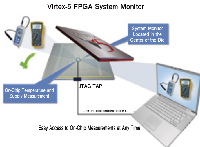
図 2 - Virtex-5 デバイスダイの中心に配置された System Monitor センサは、貴重なオンチップ電圧と温度データの提供を、製品開発段階やデバイスの量産時、あるいはフィールドに展開した後でもアクセス可能
