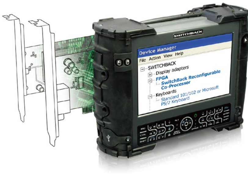
図 3 - FPGA 内に形成されたすべてのリコンフィギャブル ハードウェアはメイン プロセッサに接続でき、プロセッサは拡張ポートに挿入された実ハードウェアに対するのと同様に、これらへアクセス可能です。
