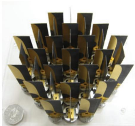
図 2. 新しい PCB アンテナを活用したマイクロ波イメージ処理用のフェーズド アレイ アンテナ
