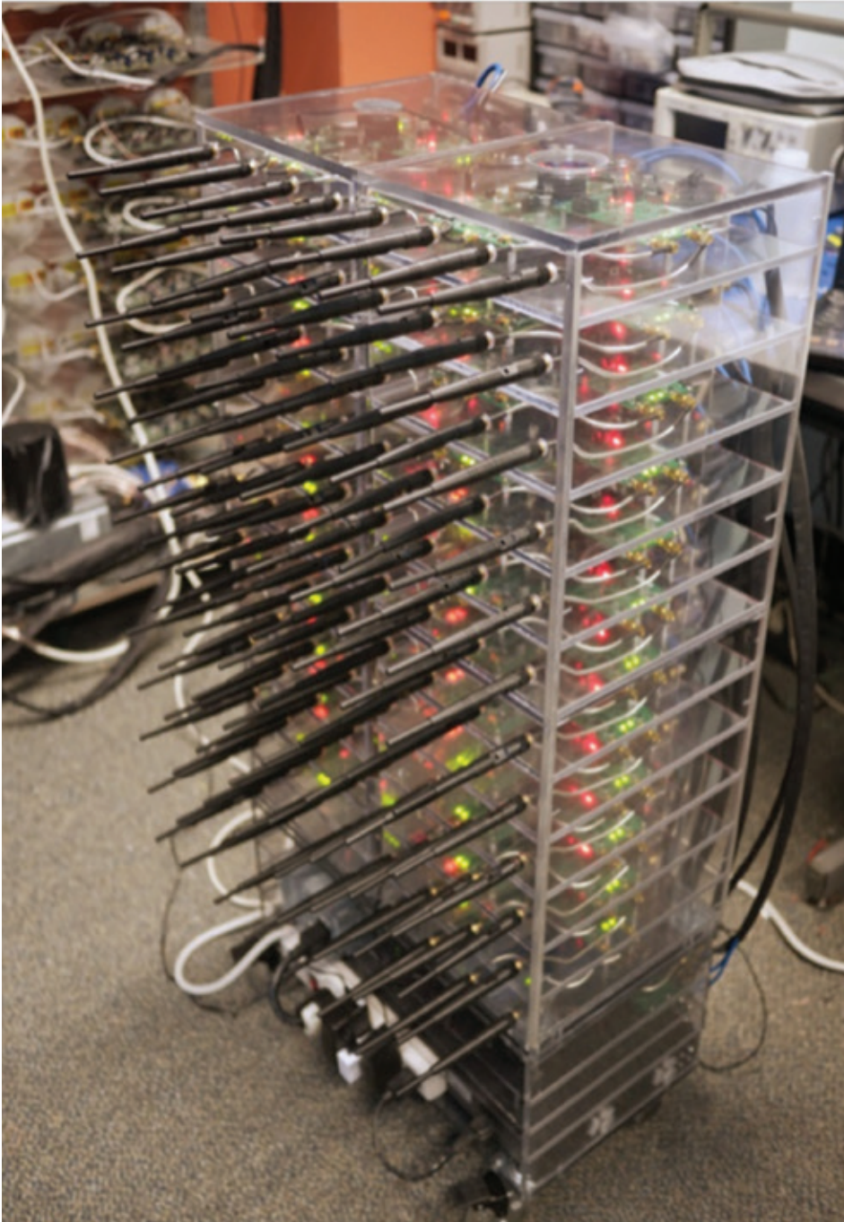
図 2 - ライス大学の Argos v2 アレイは、クロッキングとイーサネット接続を共有するクワッド無線アンテナ装備の WARP v3 ノードを 24 個組み合わせたものです。
