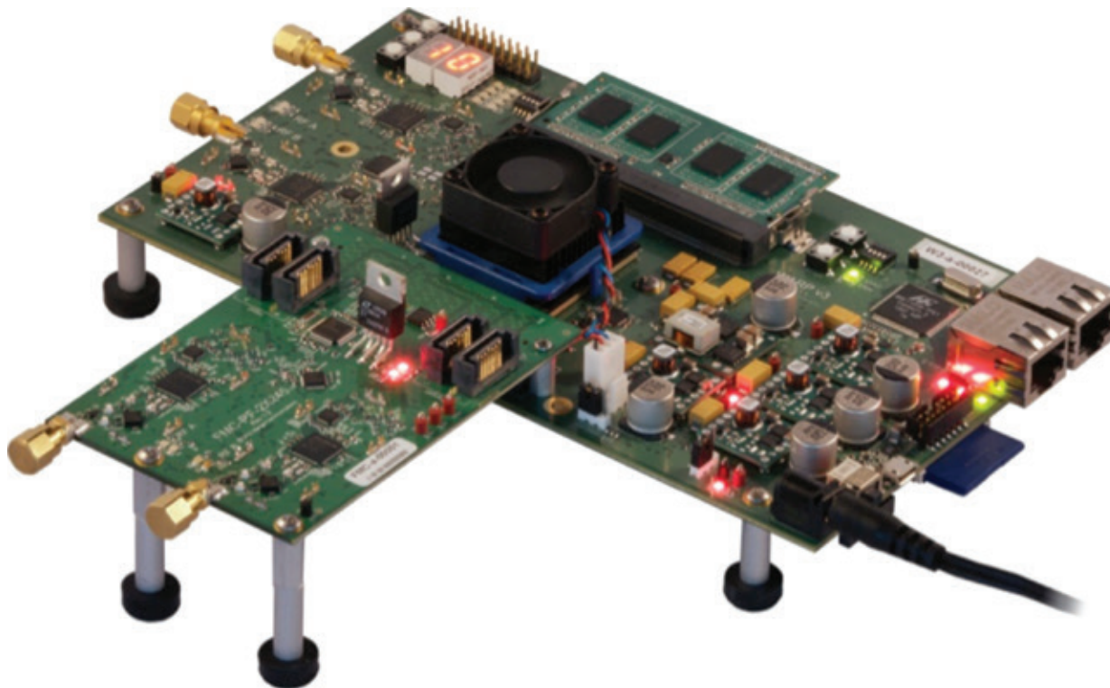
図 1 - デュアル無線 FMC モジュールを搭載した WARP v3 ハードウェアは、大規模 FPGA、4 つの RF インターフェイス、メモリ、2 つのイーサネット接続ポートを備えています。
