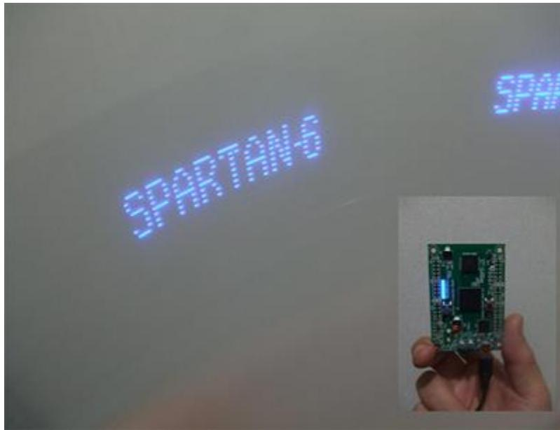
このデザインは2組のカウンタとLUTを利用した深さ64、幅8bitの64x8の分散RAMを使用した小さなデザインです。一つ目のカウンタは、50MHzのクロックを14ビットカウンタに入力し、このカウンタが0(ゼロ)値に戻るたびに、2つめの7ビットカウンタのクロックを有効にします。その7ビットカウンタの LSB 6ビットが RAM のアドレスになります。約0.3msecの周期で変化するアドレスで読み出される8ビットデータを8個のLEDに出力しています。MSBビットはブランクの期間を作るのに使用しています。このメモリは、RAMとしてVHDL記述してありますが、実際には初期値を設定し、ROMのようにして使っています。プッシュボタンを押すと、Hex値の"AA"で初期値を書き変えます。このRAMの初期値は英数字を表示できるように設定していますので、8個のLEDの列を縦にして、基板を横方向に動かすと目の残像により、文字が浮かび上がるというデザインです。基板を手に取って横に動かしてみてください。早く動かすと大きく表示されているかのように見えます。文字がこの写真のように見えますか、見えたなら成功です。
