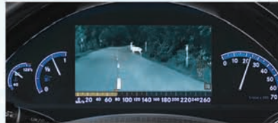
ボッシュ社の暗視システム - 計器クラスタの統合されたディスプレイ
