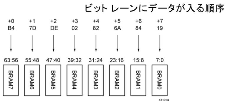
ビット レーンの定義は、ハードウェア コンフィギュレーションと一致している必要があります。BMM がハードウェア の実際の動作と異なって定義されていると、メモリ コンポーネントから取り出されたデータが不正になってしまいます。
