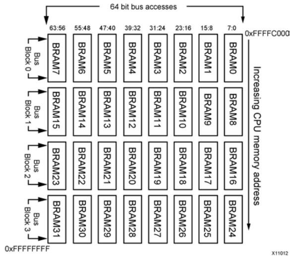
上記のレイアウトのアドレス空間には、4つのバスブロックが含まれています。右上端のアドレスは 0xFFFFC000 で、左下端のアドレスは 0xFFFFFFF です。バスアドレスには 8 個のブロック RAM からの 8 データバイトが含まれるため、バイトリニアの CPU データはブロック RAM の 8 バイトでインターリーブする必要があります。
