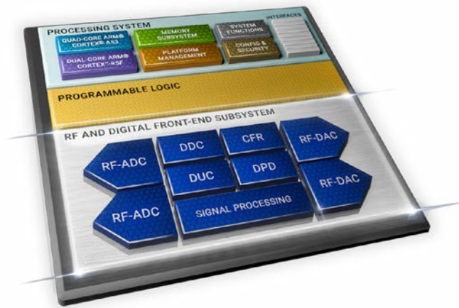
図 8 Zynq RFSoc DFE は DFE サブシステムをハード IP として統合
