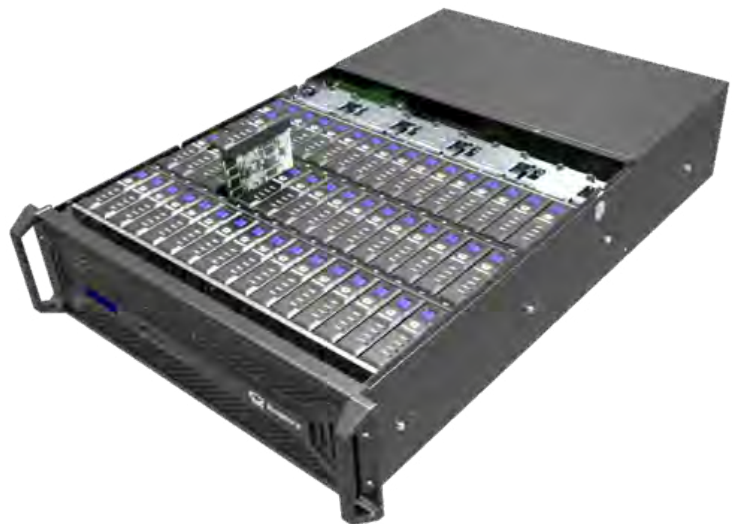
图 1：Aup2600 采用 48 片赛灵思 Zynq MPSoC 器件
