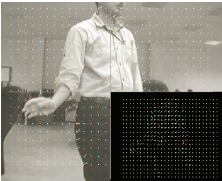
図 4 - 実際に FPGA で処理したフレーム (右下に動きベクトル グリッドを重ねて表示)
