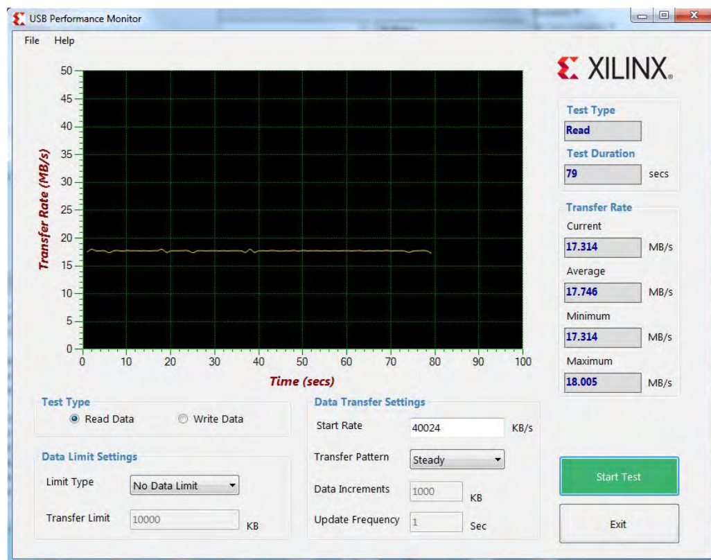
図 6: バルク トランザクションのパフォーマンス測定 (スタート レート 40024KB/s)
