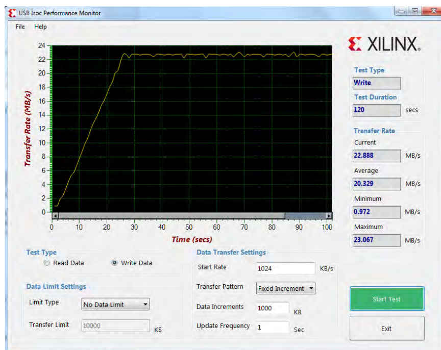
図 8: アイソクロナス Out トランザクションのパフォーマンス測定
