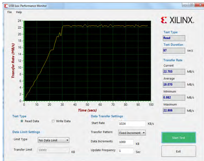
図 9: アイソクロナス In トランザクションのパフォーマンス測定
