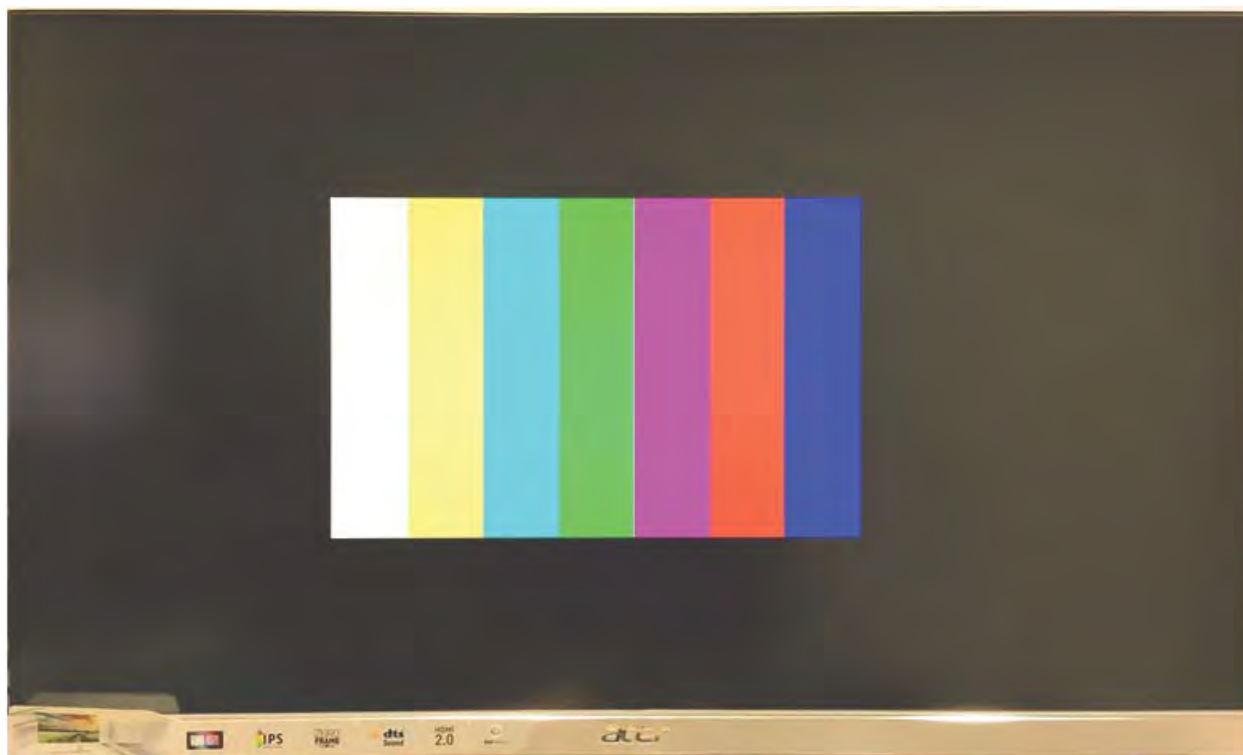
図 7: TX 専用モード - 1920x1080p60 (デフォルト) カラーバーパターン
