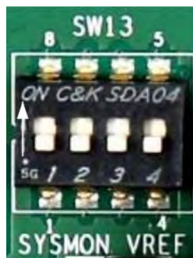
図 11: DIP SW13[1:4] を 0000 に設定
