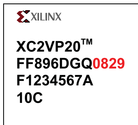
図 1: 日付コードを示すパッケージのトップマーク
