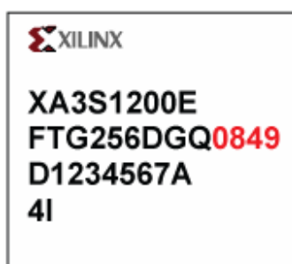
図 1 : デバイス マークの日付コードの例 (実際の日付ではない)
