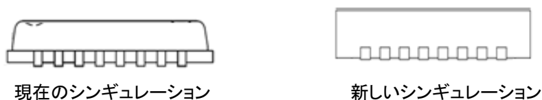
図 1：QFG32 および QFG48 パッケージの側面図 (モールド キャビティの角度)
