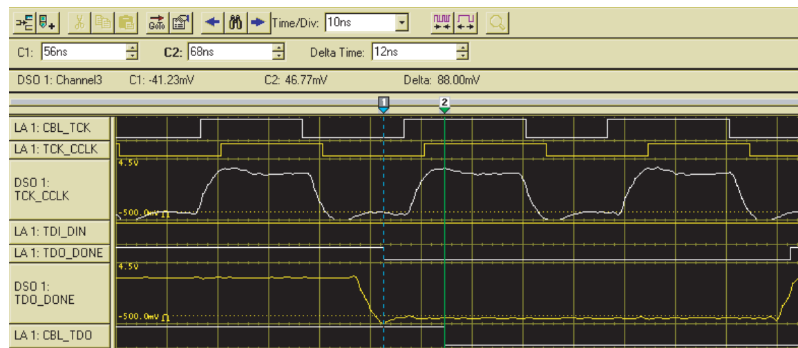
図 21 : TCK_CCLK (TDO_DONE から CBL_TDO の遅延) に対する TDO_DONE のタイミング
