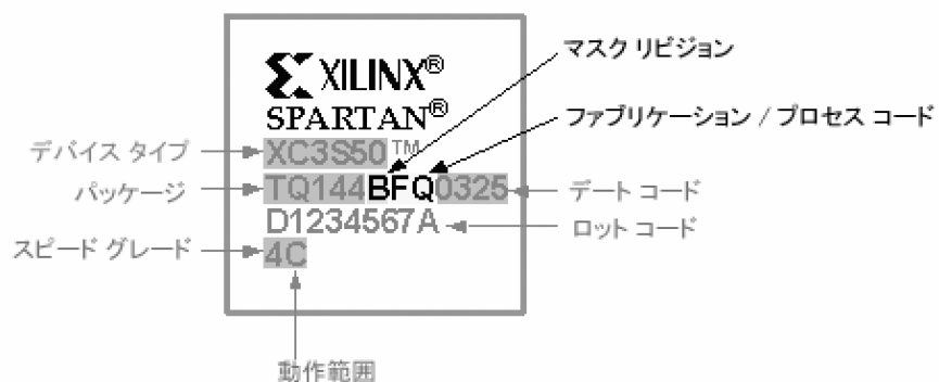
図 1 : UMC 200mm 工場 で製造されたファブリケーション/プロセス コードが「FQ」の Spartan-3 FPGA
