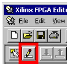
図 6 : DCM の設定を変更するために [Edit Mode] ボタンをクリック
