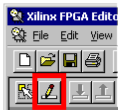
図 7 : DCM の設定を変更するために [Edit Mode] ボタンをクリック
