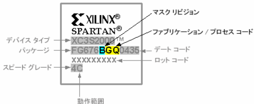
図 1 : UMC 300mm 工場で製造されたファブリケーション/プロセス コードが「GQ」の Spartan-3 FPGA
