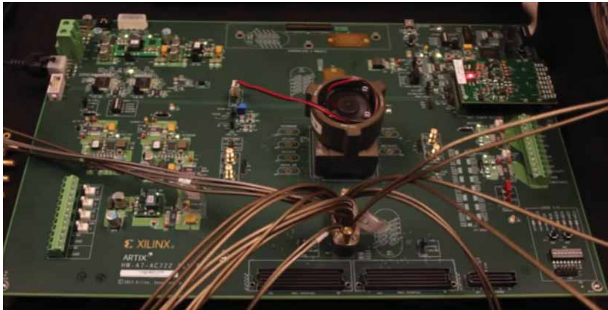
図 9： ケーブルとコネクタが接続された AC722 特性評価ボード
